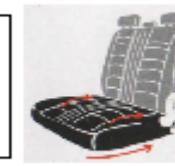
Наденьте чехлы на спинку (-и) заднего дивана, закрепите их с помощью фиксирующих элементов.
