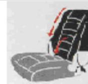
Зафиксируйте спинку имеющимися крепежными элементами (шпилька или крючки). Далее утяните заднюю часть спинки вниз и закрепите нижний хвостик под сиденьем.
